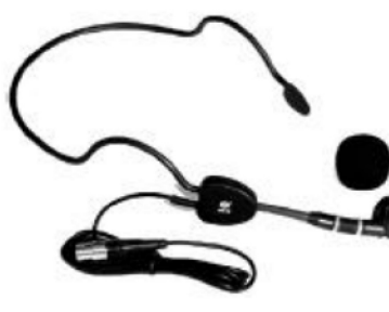
HM-58 Micrófono de Condensador Impedancia: 700 Ohmios Respuesta de Frec: 200-8KHz Sensibilidad: -68dB \pm 3 dB 1KHz Dirección: Uni-direccional Peso: 52g (0.12lb)
