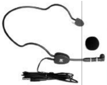
HM-38 Micrófono de Condensador Impedancia: 600 Ohmios Respuesta de Frec: 80-12KHz Sensibilidad: -68dB \pm 3 dB 1KHz Dirección: Uni-direccional Peso: 52g (0.12lb)
